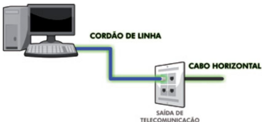
A saída de telecomunicações é composta por um espelho e tomadas. As tomadas de voz podem ser RJ-11 ou RJ-45 e as tomadas lógicas são, normalmente, RJ-45 com janela basculante retrátil automática, como mostrado na figura abaixo.
