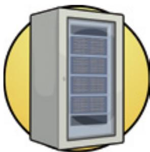
É a área no pavimento que abriga o gabinete de conexão (rack). O gabinete, por sua vez, abriga painéis de conexão (patch panels), guias de cabo, hubs, switches, ventiladores, régua para alimentação dos equipamentos, etc.
