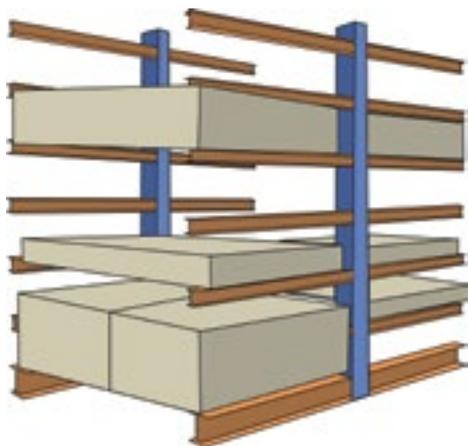
A estrutura **cantilever** é indicada para armazenagem de peças de grande comprimento, como barras e tubos, sendo formada por colunas perfuradas nas quais se encaixam os braços, cuja altura é regulada.
