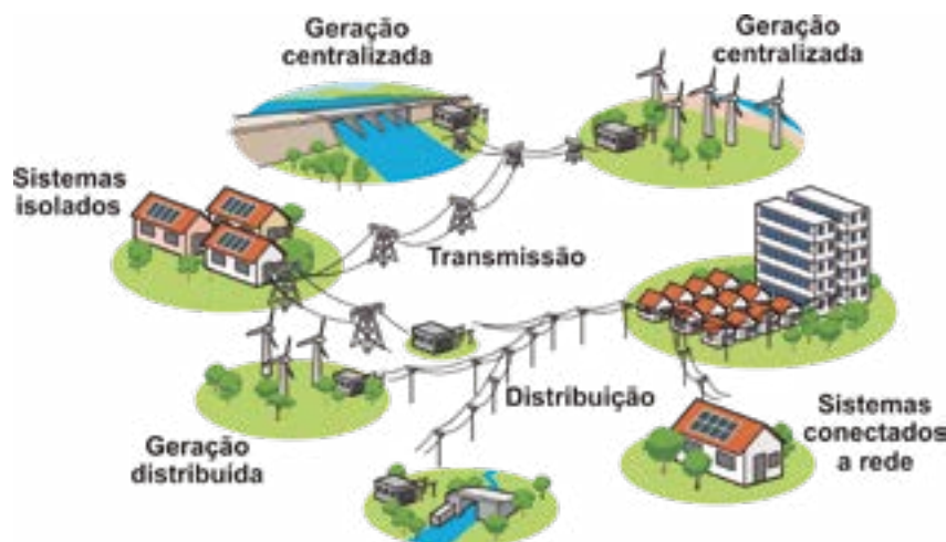
Diagrama simplificado de um sistema elétrico de potência
