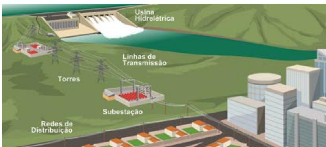
A geração é estabelecida por uma usina geradora de energia elétrica, a qual pode ser uma hidroelétrica nuclear, termoelétrica, solar ou eólica, por exemplo. A transmissão significa o transporte
