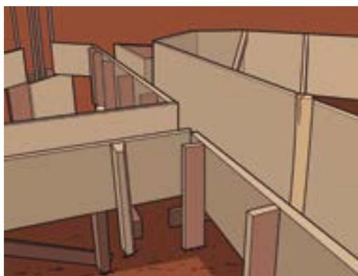
As chapas de compensado, por sua vez, possuem maior resistência normal às fibras, menor probabilidade de surgimento de trincas e uma melhor distribuição das lâminas nos sentidos vertical e horizontal, proporcionando uma distribuição das tensões, quando o material é solicitado.
