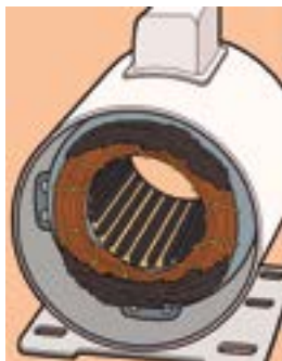
Sobreaquecimento no enrolamento principal
