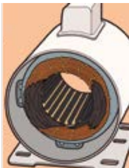
Sobreaquecimento no enrolamento auxiliar
