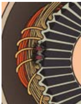
Curto entre espiras no enrolamento auxiliar
